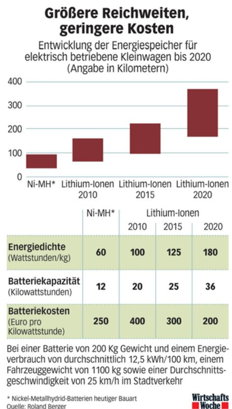
Daimler bringen die Lithium-Ionen-Akkus ein 140 kg auf die Waage. Der Nickel-Metallhydrid-Akkumulator im Prius II von Toyota besitzt ein Gewicht von 45 kg, ist allerdings auch nur für einen Hybridmodus konzipiert.
